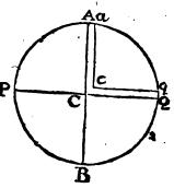
288, eo quod vis centrifuga ex circulari motu orta partem unam è ponderis partibus 289 sustinebit ac detrahet, & pondus 288 in altero crure sustinebit reliquas. Porro (ex propositionis xc1. corol. 2. lib. 1.) computationem ineundo, invenio quod si terra constaret ex uniformi materià, motuque omni privaretur, (1) & esset ejus axis P Q ad diametrum A B ut 100 ad 101: gravitas in loco Q in terram soret ad gravitatem in eodem loco Q in sphæram centro C radio P C vel Q C descriptam, ut
