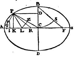
particula P urgetur secundum rectam P K Axi normalem est ad vim, qua urgetur secundum rectam P D Axi parallelam, ut  $\frac{P K \times B}{C B}$  ad  $\frac{C K \times A}{C A}$ ; adeóque ut P  $K \times K$  C ad C  $K \times K$  R. i. e. ut P L ad K R ex constructione. Quare particula P urgetur secundum rectam PR, his viribus conjunctis, & vis composita est ad B, ut P R ad B C. Quo verò pacto vires A & B computari possim , posse ostendemus.
