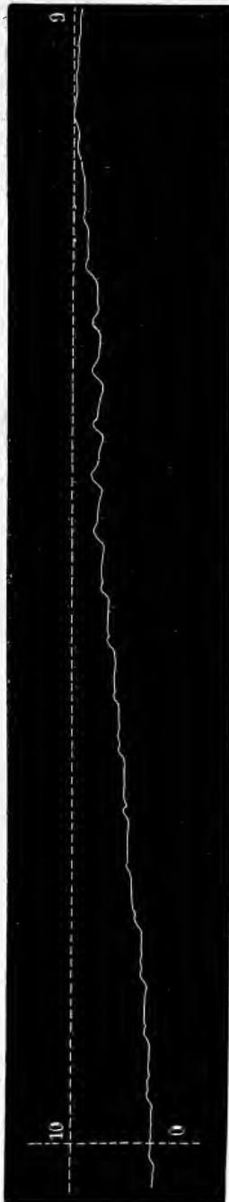
Fig. 133. — Inscription manométrique des changements de volume de l'ampoule d'un sphygmoscope soumise à des pressions extérieures variant de zéro à centimètres de mercure.
