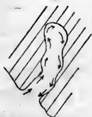
图 15 夏天空气在封闭一端朝上的溶洞中的流动。
