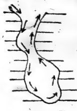
图 14 冬天空气在袋狀溶洞中的流动。
