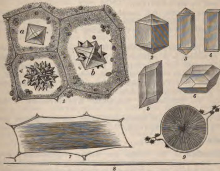
Krystallformen des Kalkoxalates (aus Reinke). 1 a Einfaches Quadratocäeder, b desgleichen mit aufgesetzten kleineren Octaëdern, c Druse. — 2 und 3 Quadratische Säulen mit aufgesetztem Octaëder. — 4 Quadratische Säule. — 5 Monokline Säule. — 6 Dieselbe mit Abstumpfung der zwei an beiden Endflächen sich diagonal gegenüberliegenden Kanten. — 7 Raphiden. — 8 Krystallnadel. — 9 Sphärokrystall.
