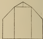
Abb. 57 Dach: Dachwerk auf dem Firstbalken ruhend.
