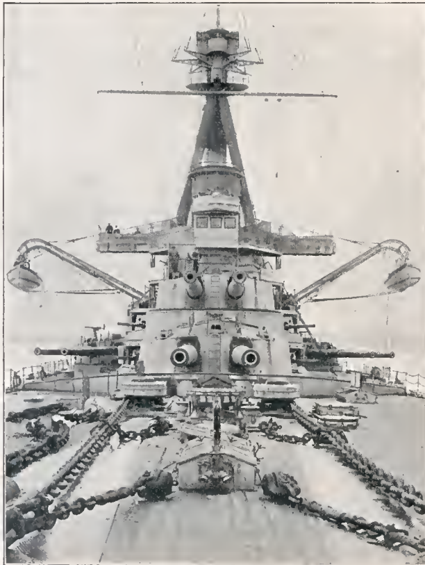
Vorderdeck eines ausländischen „Dreadnought“ mit schweren 30,5-cm-Geschützen.
