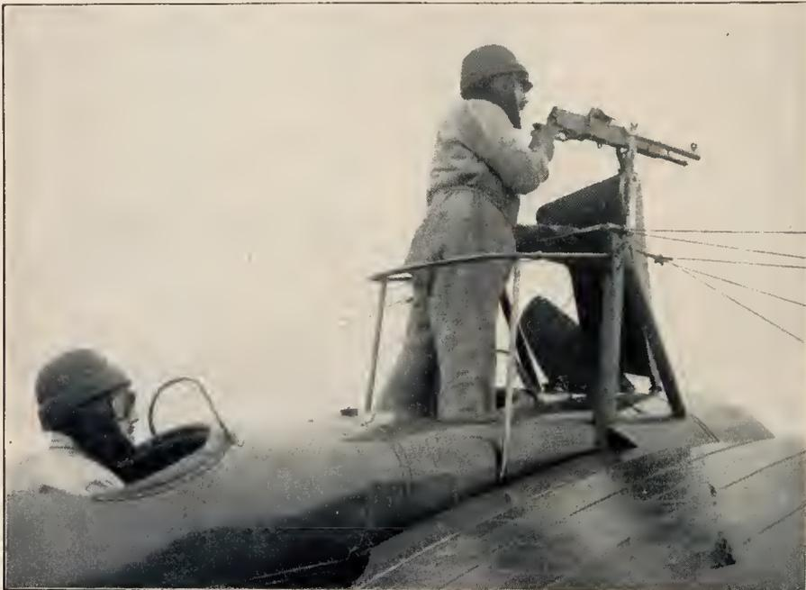
Ein gepanzertes französisches Flugzeug, ausgerüstet mit einem Geschütz zur Vernichtung gegnerischer Flugzeuge und zur Jagd auf Luftschiffe. Mit dem Flugzeug wurden kurz vor Ausbruch des Krieges in Villacoublay bei Paris Versuche gemacht. Von Erfolgen dieser Panzerflugzeuge hat man bisher ebensowenig gehört, als von der Kriegerinvasion, durch die am ersten Kriegstag die Rheinbrücken und die Hauptbahnhöfe auf der deutschen Ausmarschlinie zerstört werden sollten.
