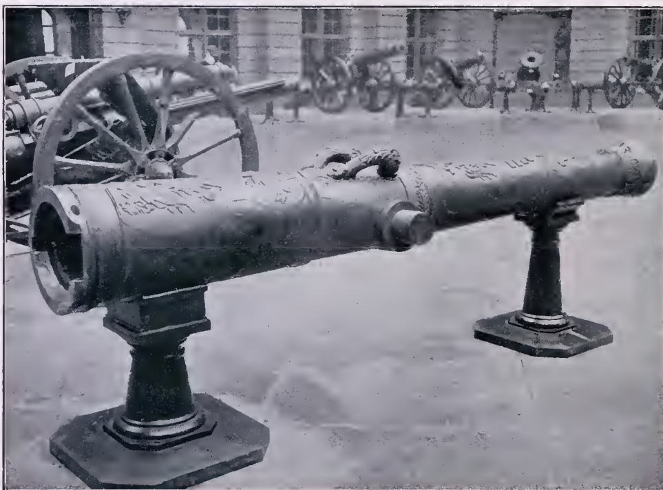
Alte französische Bronzekanone, die mit verändertem Verschlussstück während des jetzigen Krieges im französischen Heere als Minenwerfer verwendet wurde und nun als Siegesbeute im Berliner Zeughaus aufgestellt ist.
