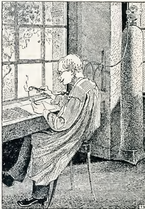
Wie der Kriegsring entsteht: Das Eilen des Ringbandes in der Knallgasflamme.
