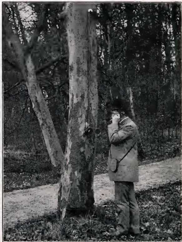
Merkwürdige elektrische Apparate. Links: Der Spazierstock als Schienenprüfer bei elektrischen Bahnen. Der Spazierstock des Ingenieurs ist so eingerichtet, daß dieser durch Abhören mit einem Telephon Störungsstellen beim Begehen der Bahnstrecke auffinden kann. Rechts: Der Fernsprecher in der Westentasche, mit dem man sich an feststehende Fernsprechleitungen anschließen kann
