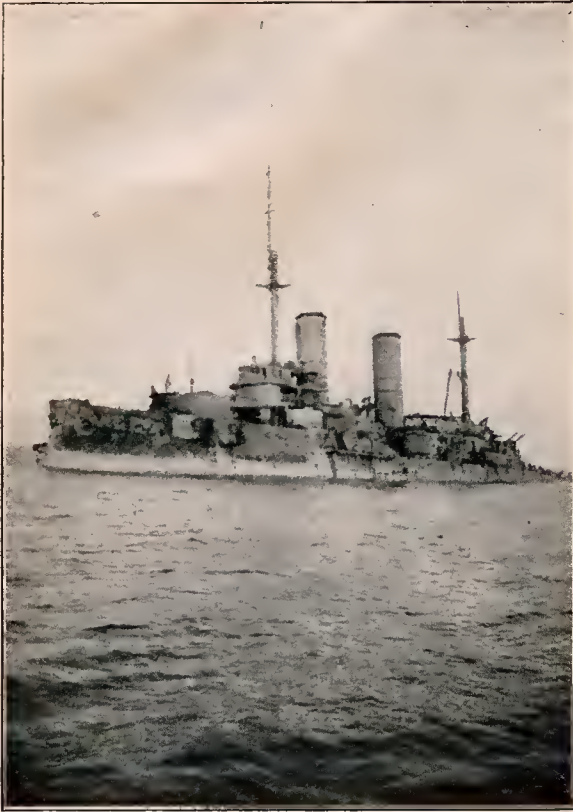
Das Wrack des russischen Linienschiffs „Slawa“, das in den Kämpfen um Desel von deutschen Kriegsschiffen in Brand geschossen wurde und brennend im Moonfund von seiner Besatzung auf Strand gesetzt wurde. Das Schiff, dessen Wrack in deutschem Besitz ist, verdrängte 13700 Tonnen, war 119 m lang und 23 m breit und hatte 38 Geschütze an Bord, darunter vier von 30,5 cm.
