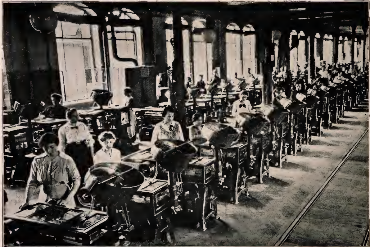
Deutsche Frauen in einer großen Munitionsfabrik: Revision der Patronenhülsen mittels Maschine. Phot. Gebr. Saeckel.
