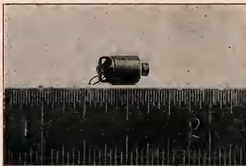
Der kleinste Elektromotor der Welt. Der Motor ist nur halb so groß wie das Bild; er ist ein Meisterstück der Präzisionsarbeit und vollkommen betriebsfähig. Die Länge der Achse beträgt 6 mm, die Höhe des Motors 3,5 mm, das Gewicht 1,5 g.
