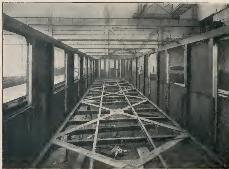
Tragwände und Untergesell eines eisernen Personen-D-Zugwagens.
