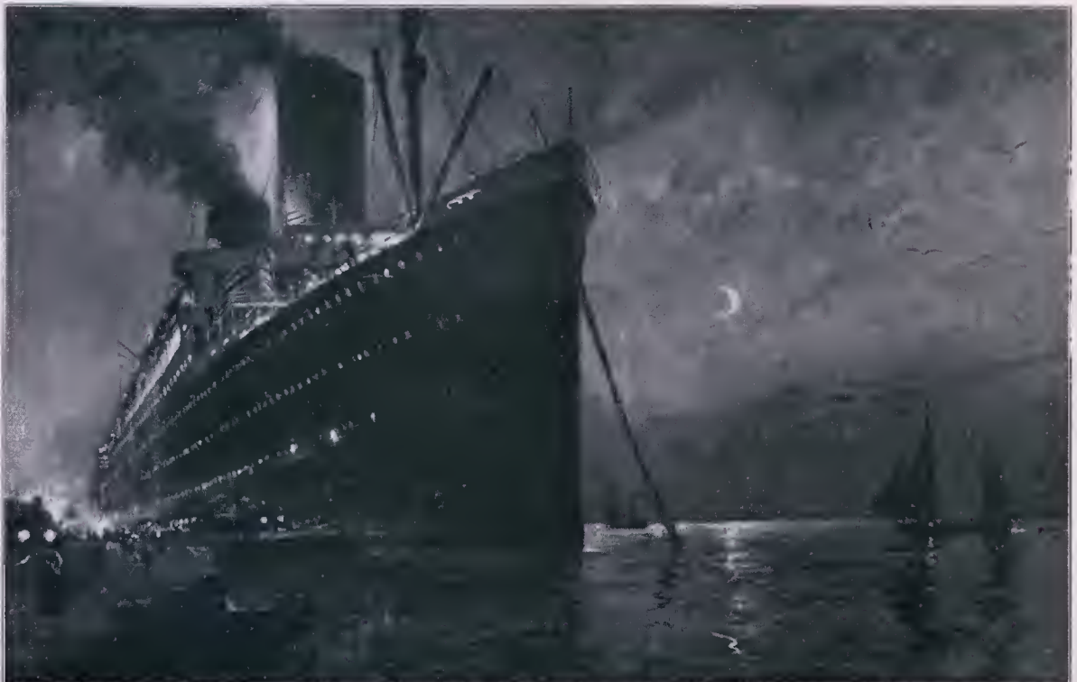
Der noch im Bau befindliche Doppelschrauben-Personen- und Frachtdampfer „Kolumbus“ des Norddeutschen Lloyd. (Länge 236,2 m, Breite 25,3 m, Tiefgang 10,4 m. Brutto-Rauminhalt 35 000 Register-tonnen). Auf dem Dampfer, der am 17. Dezember 1913 auf der Danziger Schichau- & Werk von der Kronprinzessin Cecilie getauft wurde, können rund 3500 Personen und eine Auladung von 10 000 Tonnen befördert werden.
