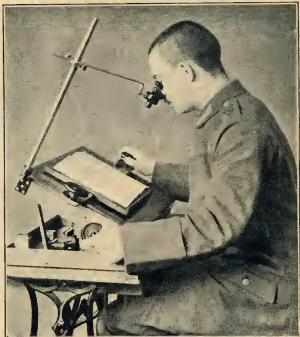
Lesepult mit molekularer Fernrohrlupe für hochgradig Schwachsichtige.
