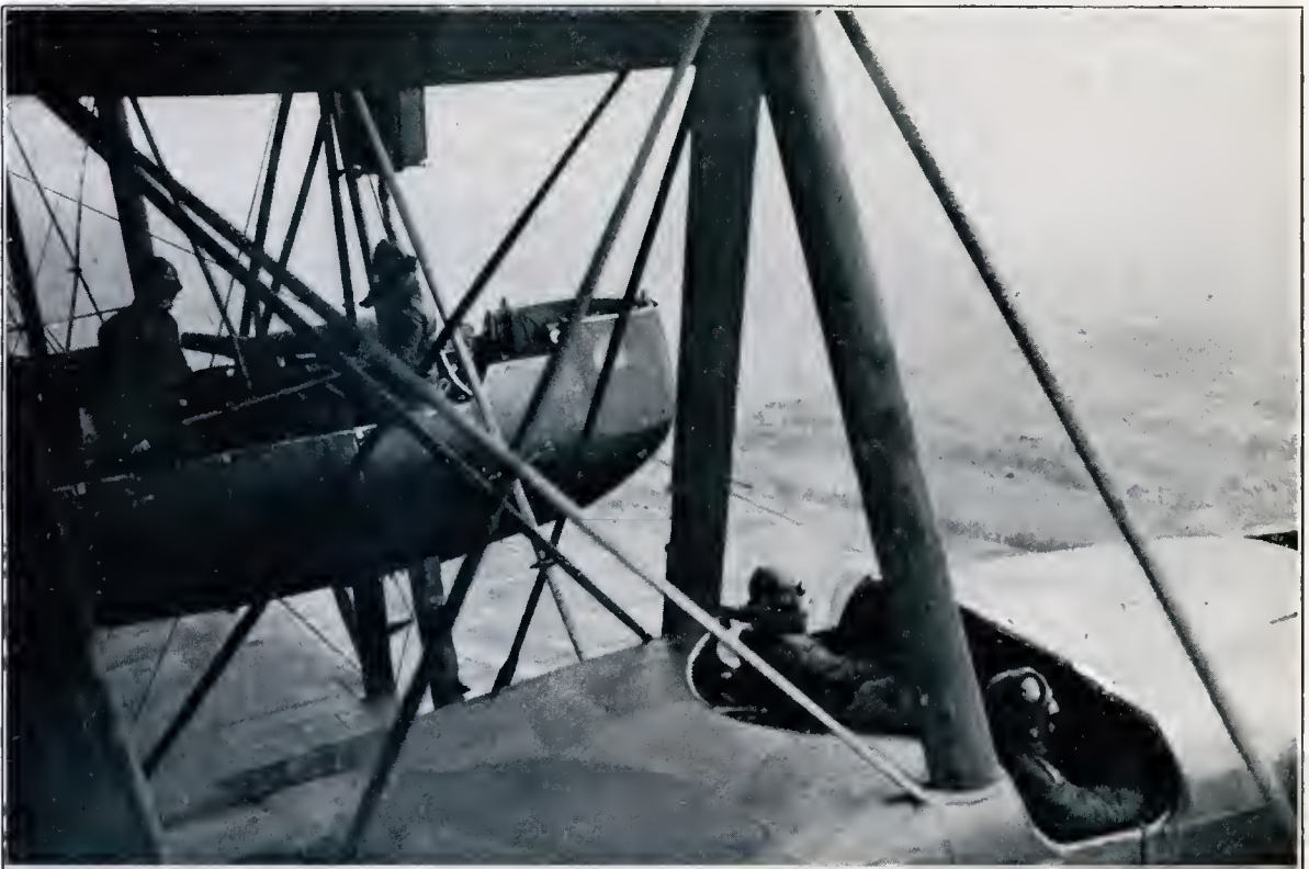
Blick von der rechten Motorengondel eines Riesenflugzeugs auf die andere Motorengondel. vorn der Mittelrumpf.
