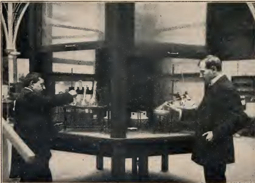
Destillierraum mit Abzug für giftige und äbelriechende Gase im Laboratorium des Kriegsausschusses für Öle und Fette.
