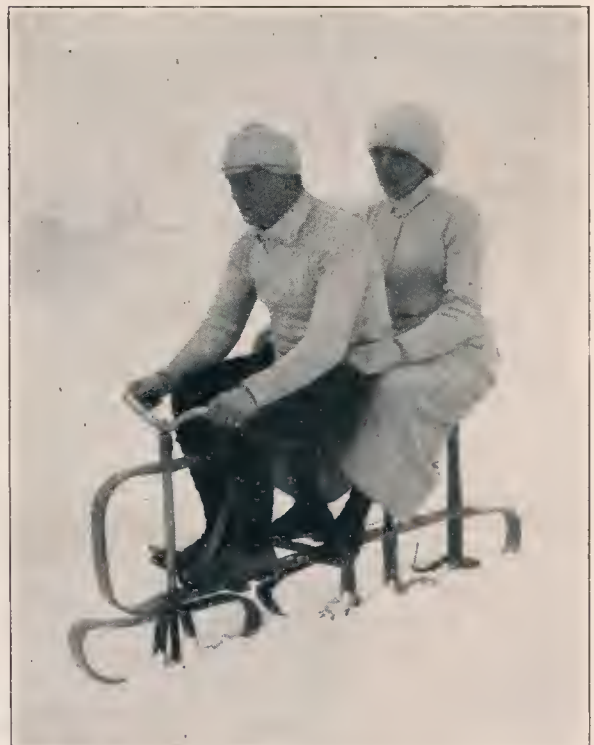
Ein neuer Rodelschlitten. Er hat statt zweier nur eine geteilte Stufe, deren Vorderstück lenkbar ist.
