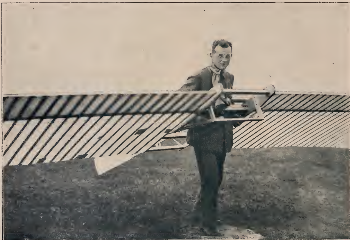
Neue erfolgreiche Flugversuche mit einem motor- und spannungslosen Lindeder unternahm der Gleitflieger Hans Richter. Die Tragflächen des Segelflugzeuges besitzen keine Wölbung, sondern stellen sich elastisch auf den Winddruck ein. Ein vertikales Steuer regelt die Flugrichtung. Phot. H. Zennede
