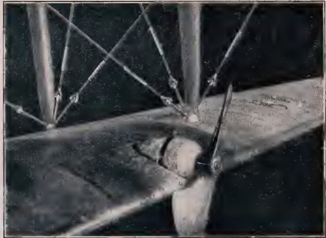
Propeller mit Dynamo in der Tragfläche des Flugzeugs. Der mit dem Propeller auf einer Achse sitzende Dynamo dient zum Antrieb des Kreislaufs im Dreherischen Steuerzeiger zur Beleuchtung, Heizung usw. Der Propeller wird durch den beim Fahren erzeugten Gegenwind in Umdrehung verfest.
