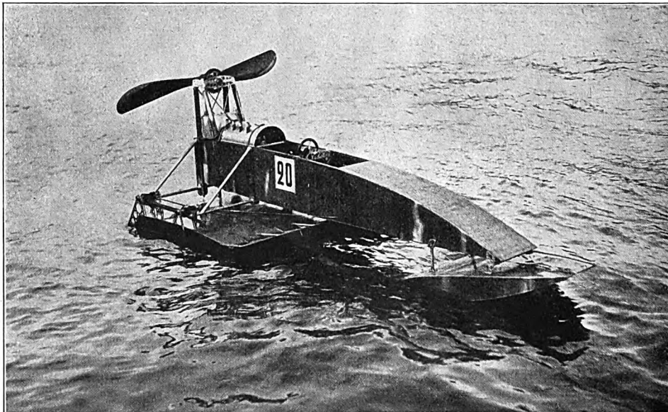
Ein Wasserautomobil. Der Franzose Lellier hat einen Wassergleitflieger erbaut, der ein Mittelglied zwischen einem Wasserflugzeug und einem Gleitboot bildet. Das sonderbare Fahrzeug, das mit einem 50 pferdigen Motor ausgerüstet ist, entwickelt eine große Geschwindigkeit und wird nach Ansicht des Erfinders besonders in den französischen Kolonien auf Gewässern mit niedrigerem Wasserstand als Verkehrsmittel gute Dienste leisten.
