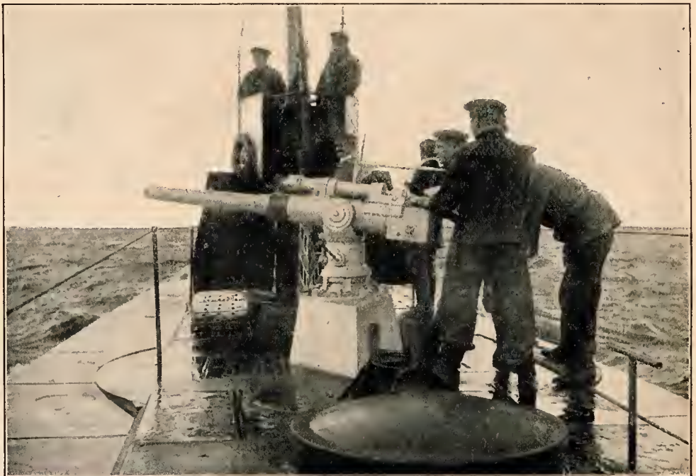
Am Schnellfeuergeschütz eines deutschen U-Boots. Die neuen Untersee-Kreuzer sind mit zwei solcher weittragenden Geschütze ausgerüstet.
