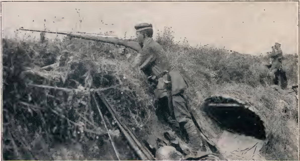
Ein deutsches Gewehr zur Bekämpfung der Tanks; das Gewehr ist schwerer im Bau, führt stärkere Munition als die gewöhnlichen Infanteriegewehre und wird von den Gegnern sehr gefürchtet, denn die Tankbesatzungen verlassen vielfach nach dem ersten Treffer den Tank. Phot. Bild- und Filmamt.
