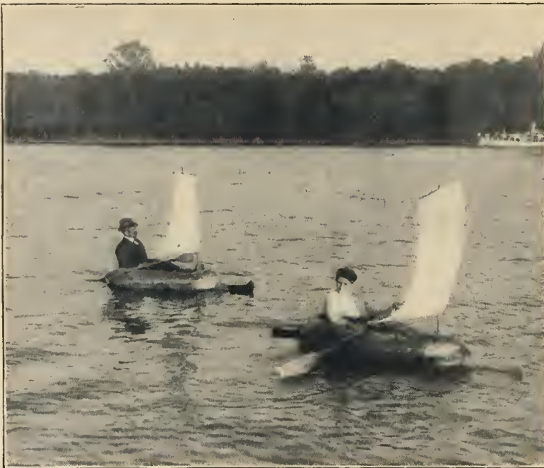
Ein zusammenlegbares Miniatur-Segelboot; es wiegt 15 Pfund, läßt sich zusammenlegen und somit im Koffer tragen. Vor dem Gebrauch wird die Bootfassung aufgepumpt.
