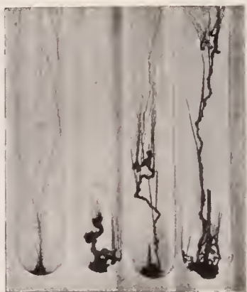
FIG. 16. — Sulfate de manganèse et silicate de potasse (concentrations diverses). Arborescences d'un blanc jaunâtre.
