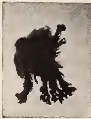
FIG. 2. — Croissance en algue. Granule de Sulfate de cuivre : Milieu : Ferrocyanure 2 p. c. ; Chlorure de sodium 1 p. c. ; Gélatine 1 p. c.
