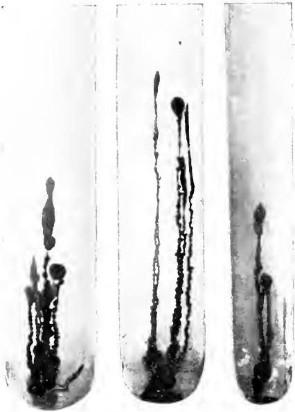
FIG. 11. — Granules de ferrocyanure de potassium et de sucre. Milieu \text{SO}^4 \text{Cu} 5 p. c.; \text{Na Cl} 2,50 p. c.; Gélatine 1 p. c.
