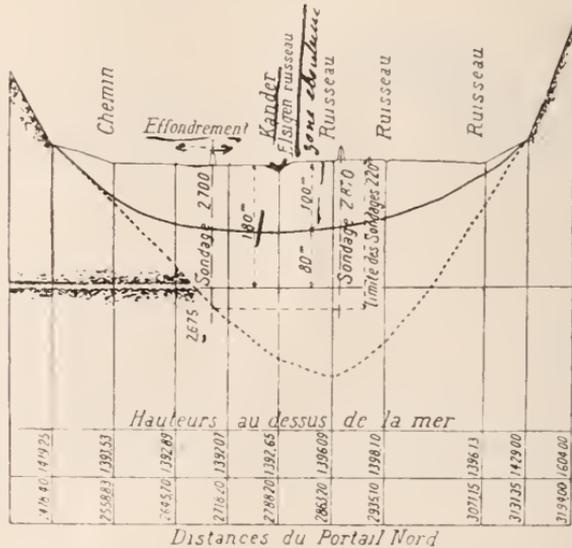
FIG. 7. — Schéma de la catastrophe du 28 juillet 1908
