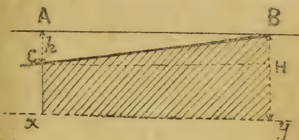
Fig. 35. — Ligne de niveau AB et ligne de pente BC , rapportées suivant un plan de comparaison xy .
