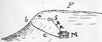
Fig. 39. — Tracé d'une ligne de pente contournant un coteau pour une adduction d'eau.
