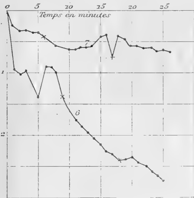
Fig. 5. — Courbes montrant l'électrisation de l'air au travers duquel on a laissé tomber des gouttes d'eau. — La courbe 6 a été obtenue après avoir laissé tomber les gouttes d'eau pendant quelques instants seulement; la courbe 7 après que l'eau eut coulé pendant 16 heures et que l'air eut été ainsi débarrassé de la majeure partie de ses poussières. — Les abscisses représentent le temps en minutes; les ordonnées les volts négatifs. — Les signes X indiquent le moment où chaque goutte d'eau est tombée.
