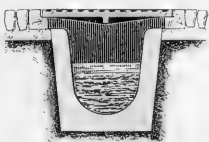
Fig. 3 bis. — Détail du transporteur hydraulique. — Coupe verticale. — Le transporteur est constitué par un caniveau en maçonnerie où de l'eau coule avec une certaine vitesse. Pour s'en servir, on enlève le couvercle, et on laisse tomber, par petites quantités, les betteraves, dans le caniveau. Elles sont entraînées par l'eau jusqu'au laveur.
