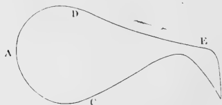
Fig. 2. — Diagramme des températures d'un point de la paroi métallique. A, commencement de l'admission; D, commencement de la détente; E, commencement de l'émission; C, commencement de la compression.
