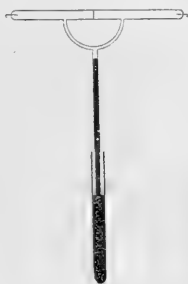
Fig. 1. — Tube à décharge. — Le tube est horizontal et séparé en deux compartiments égaux par une mince cloison verticale de platine ou de mica. Les deux compartiments sont reliés l'un à l'autre par un ajutage semi-circulaire, que supporte un tube barométrique vertical. Ce dernier tube plonge dans une éprouvette remplie de mercure.
