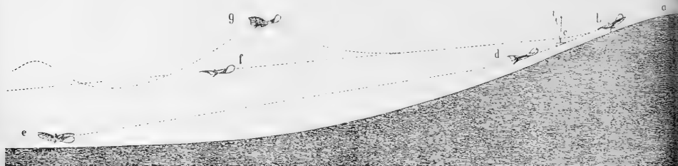
Fig. 3. — Différentes trajectoires suivies par M. Lilienthal dans son vol.
