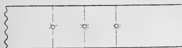
Fig. 1. — Distribution monocyclique à deux fils. — Poids de cuivre employé = 100. — Les fils sont ici représentés schématiquement par les deux lignes parallèles horizontales. Perpendiculairement à ces lignes se voient trois fils secondaires alimentant chacun une lampe.
