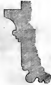
Fig. 14. — Profil de la porte latérale de l'église de Moné tés Koras
