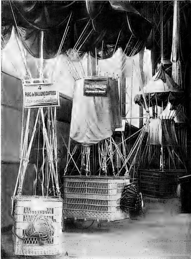
Fig. 15. — Nacelles et suspentes croisées à balancines. — A, B, suspentes pour ballons captifs; C, suspension pour ballon libre; m, ancre-herse. (Exposition de 1900.)
