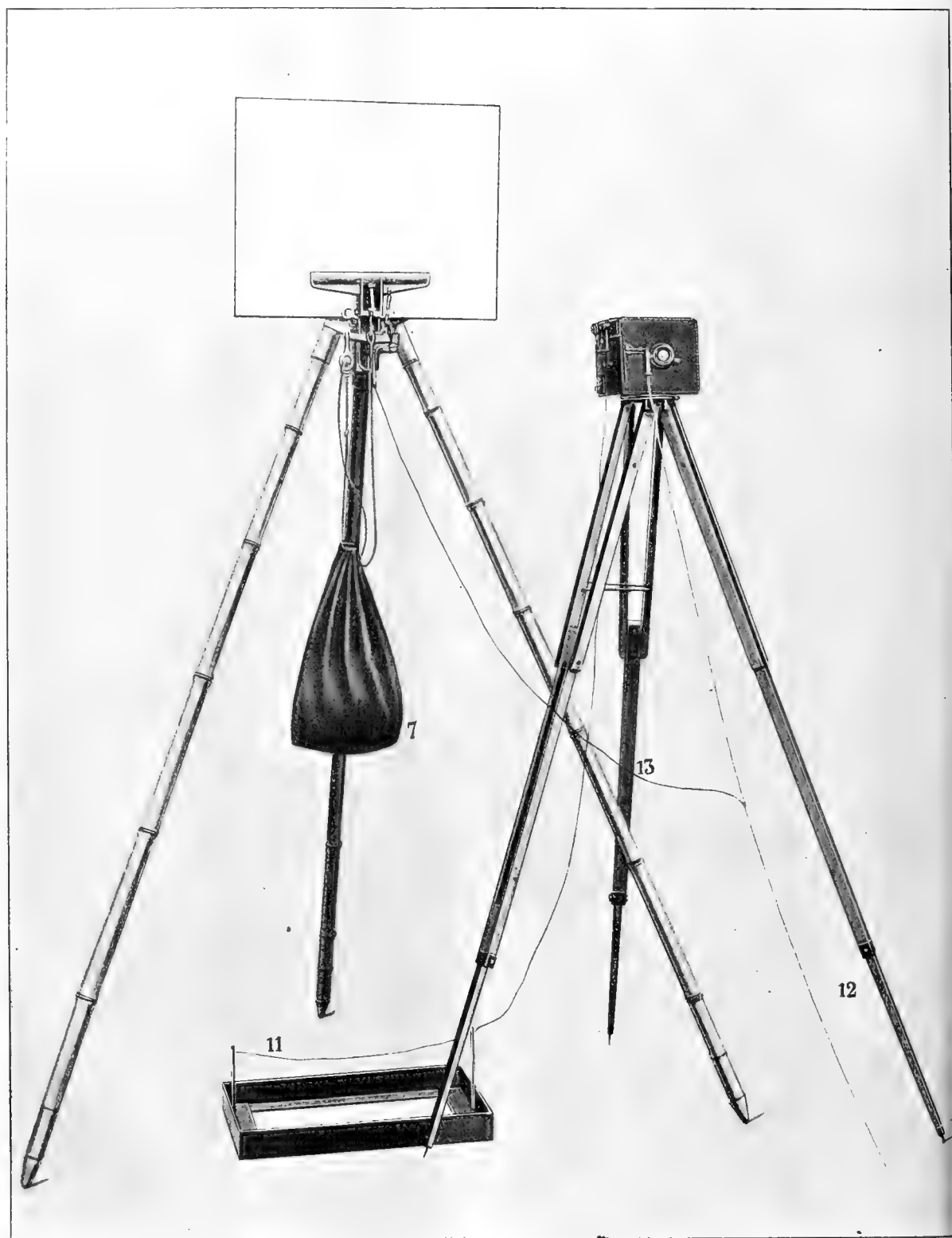
Fig. 1. — Ensemble des appareils pour la photographie animale automatique. — 12, 13, cordons tendus par le mouvement de l'animal; 11, cordon tendu par la chute du sac de sable 7.
