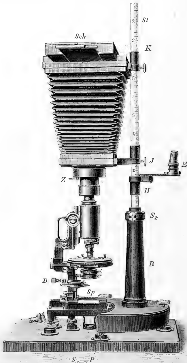
Fig. 1. — Microscope et chambre sur le dessus de table pendant la pose (env. \frac{1}{3} grand. nat.). — S_1 , vis servant à maintenir le socle du microscope; P , prisme à réflexion, en cristal de roche, pour renvoyer le faisceau horizontal de lumière incidente sur l'axe du microscope; S_p , miroir plan pour observer l'image de l'étincelle sur la plaque de verre d'urane; D , porte-diaphragme, recevant le verre d'urane, écarté hors de l'axe. La signification des autres lettres est donnée au bas de la figure 2.
