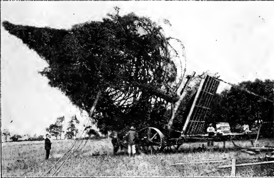
Fig. 84. — Chargement d'un arbre : vue prise lors du redressement.
