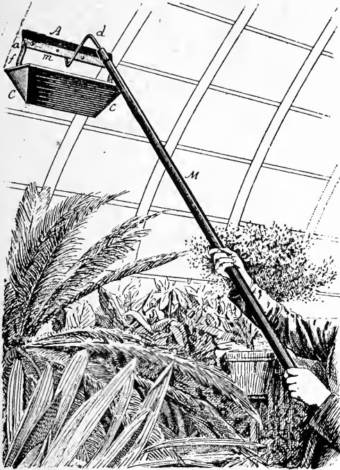
Fig. 111. — Raclette Henri Chantin pour le nettoyage des serres.
