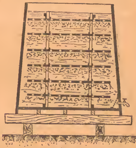
Рис. 88. Чан с шестью ложными днами сист. Перре.
