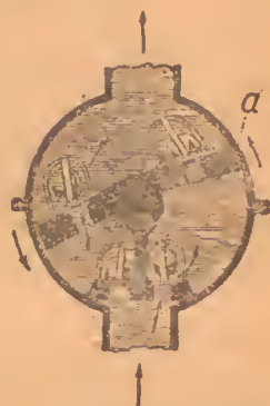
Рис. 108. Разрез крыльчатой помпы с шаровыми замыкателями (по Бабо и Маху).
