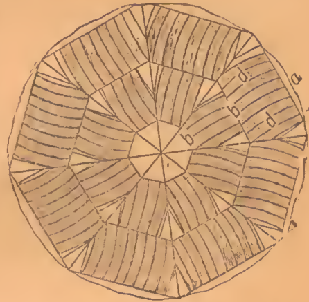
Рис. 206. Схема разделки дубового ствола на клепки.
