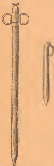
Рис. 237. Ливера для доставания проб вина из бочек.
