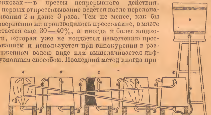
Рис. 86. Схема простейшей системы извлечения спиртосодержащих жидкостей (диффузной). V — водонапорный бак. А, В, С, D, E — чаны для наполнения выжимкой. F — выходное отверстие для спиртосодержащей жидкости. Рис. К. С. Духанина.
