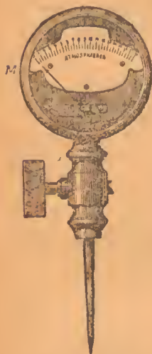
Рис. 200. Афрометр Момпе для определения давления газа в шампанском.
