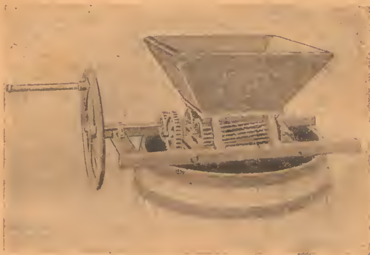
Рис. 8. Простейшая виноградная дробилка на деревян. брусьях.
