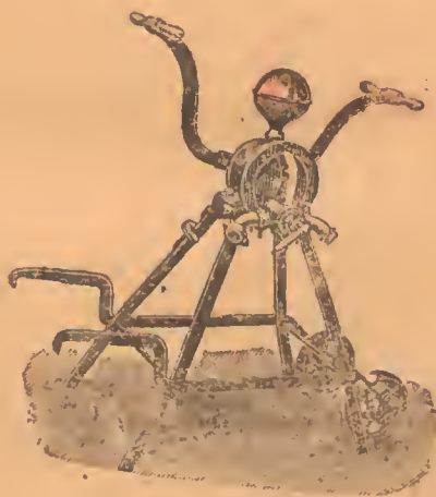
Рис. 110. Крыльчатая помпа Зейтца «Этна».
