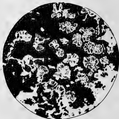
Abb. 5. Verkieseltes Eisenerz aus dem Lager „Schellenbergseite“; schwarz: Eisenoxyd, weiß: Kieselsäure, schraffiert: durch Eisenoxyd pigmentierte Kieselsäure. 30:1
