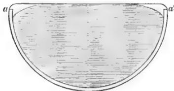
eine kleine klare Stelle. An zahlreichen anderen Gefäßen wurde dieselbe Erscheinung mit Hilfe von Capillaren beobachtet, so auch an einer halbkugelförmigen Schale von  $5^{\text{cm}}$  Durchmesser (Fig. 29). Der Nebel trat bis zur Oberfläche, und nur an den Seiten
