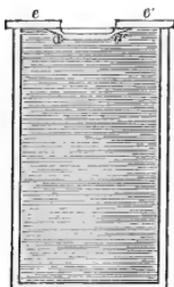
(Fig. 17), so befindet sich nach der Füllung mit dem Reactionsgemisch die Flüssigkeitsoberfläche in der Mitte des Gefässes. Der tote Raum wird dann von dem Chloroformnebel in der Weise begrenzt, dass zuerst die Oberfläche desselben parallel mit der ebenen Oberfläche der Flüssigkeit verläuft, dann sich dort umbiegt wo die Flüssigkeitsoberfläche in die Höhe steigt und schliesslich in schräg aufsteigender Richtung sich nach den bedeckenden Glasplatten  $e$  und  $e'$  zu wendet.
