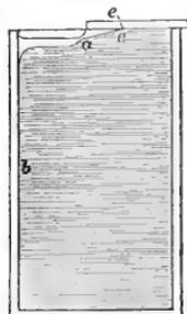
Flüssigkeitsmeniscus (Fig. 14 und 15) ist stets an der seitlichen verticalen Wand  $b$  das Profil der Chloroformnebelfläche nach unten entgegengesetzt dem Meniscus abgebogen. Auf der Seite der bedeckenden Glasplatte  $e$  dagegen, dort wo die Flüssigkeitsoberfläche sich nach oben wendet, ist die grösste Annäherung des Nebels an dieselbe bei  $a$ . Von diesem Punkte an geht das Profil der Grenze des Nebels als gerade schräg auf-
