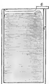
gehende schräg aufsteigende Oberfläche des Chloroformnebels. Dieselbe legt sich jedoch nicht an die obere Glaswand an, sondern biegt nach der verticalen Wand ab und schliesst bei  $c$  an dieselbe an. Diese Versuche machen es wahrscheinlich, dass ausser der Flüssigkeitsoberfläche die feste Glaswand sich an der Bildung des toten Raumes beteiligt. Um daher den gemeinsamen Einfluss der Wand und der Flüssigkeitsoberfläche weiter zu verfolgen, wurden folgende Versuche angestellt.
