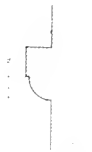
Obr. 226. Vstupy, Kostel sv. Martina. Římsce pod emporem.
