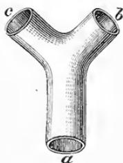
ebensoviel wie durch *b* fließen, wenn die Ballons gleichstark comprimirt und beide leer waren. Ist aber z. B. der Ballon an *c* stärker comprimirt gewesen oder noch besser, war der an *b* halb mit Flüssigkeit gefüllt geblieben, so wird viel mehr durch die Mündung *c* fließen, und die Füllung der beiden Ballons wird nachher dennoch nahezu die gleiche sein.
