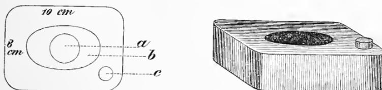
förmige Öffnung für den Durchtritt des Lichtes, *b* die centrale Lichtung für das Ei, *c* die Öffnung zum Eingiessen und Ausgiessen des Wassers. Diese Eiwärmer werden bei jedem Transport benutzt.
