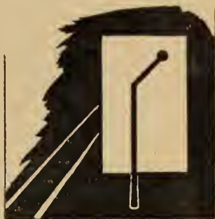
Abb. 7. In Amerika hat man mit Erfolg versucht, auch bei Nacht Form- statt Farbensignale anzuwenden, indem man hinter dem Signal eine durch Reflektoren scharf beleuchtete Wand aufstellt, von der sich das Schatten- bild des Signals gut abhebt.
