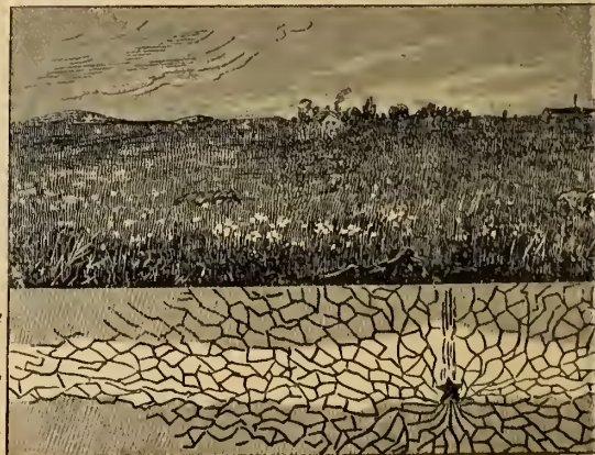
Abb. 4. Schematische Darstellung der Sprengung wasserundurchlässiger Bodenschichten durch Dynamit zur Trockenlegung sumpfiger Ländereien; a Oberfläch, b undurchlässige Schicht, c Unterfl.
