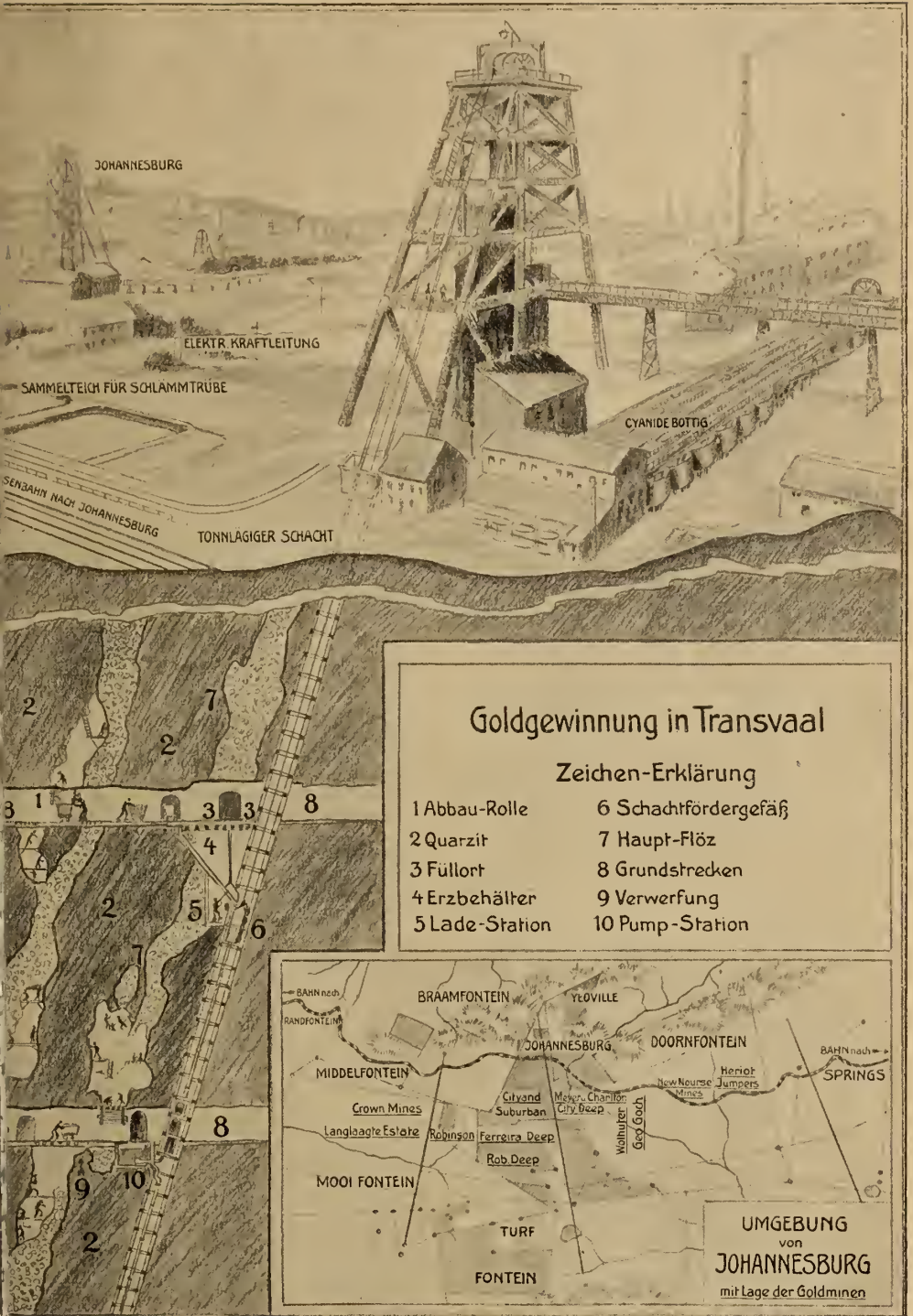
3. Schematische Darstellung der Anlagen eines Goldbergwerks in Transvaal nebst Karte der Goldminen in der Umgebung von Johannesburg.
