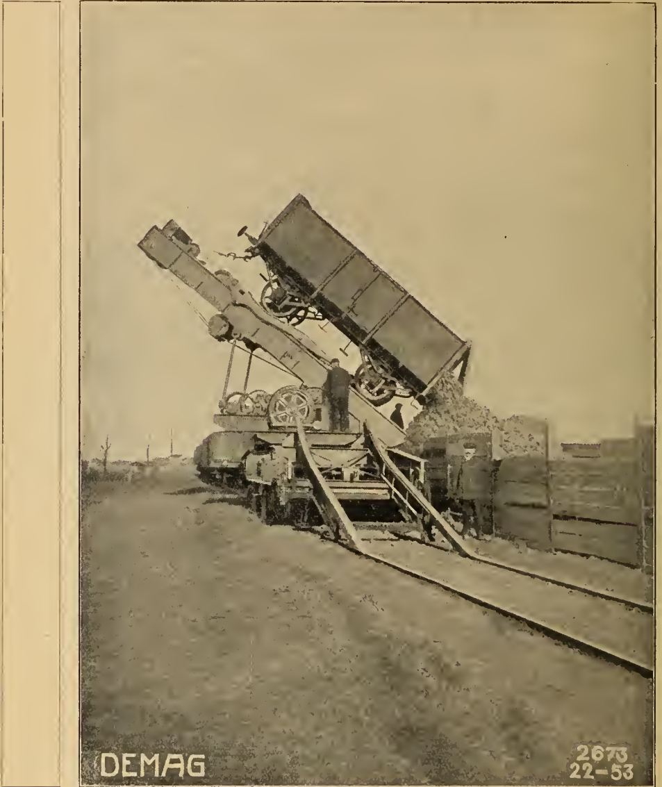
Abb. 4. Der bei 30^\circ Neigung geöffnete Wagen wird auf 45^\circ geneigt, um die vollständige Entleerung zu bewirken.
