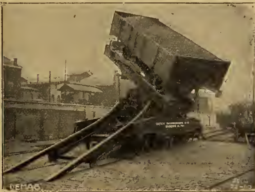
Abb. 3. Der zu entleerende Wagen wird um 90° gedreht und dann geöffnet.
