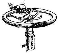
FIG. 4.—ELECTRICALLY HEATED GRIPS.
