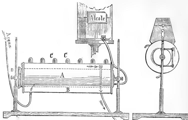
A, serbatoio cilindrico di ottone, comunicante coi lucignoli C C..., e che rimane sempre pieno di alcole, a livello costante, essendogli fornito dal caricatore in alto; B, altro cilindro che circonda tutto all'intorno il serbatoio dell'alcole, ed in cui si rinnova di continuo un afflusso di acqua a temperatura ordinaria, ad impedire lo scaldamento dell'alcole; D, indicatore per osservare se l'alcole contenuto in A si mantiene all'altezza voluta.
