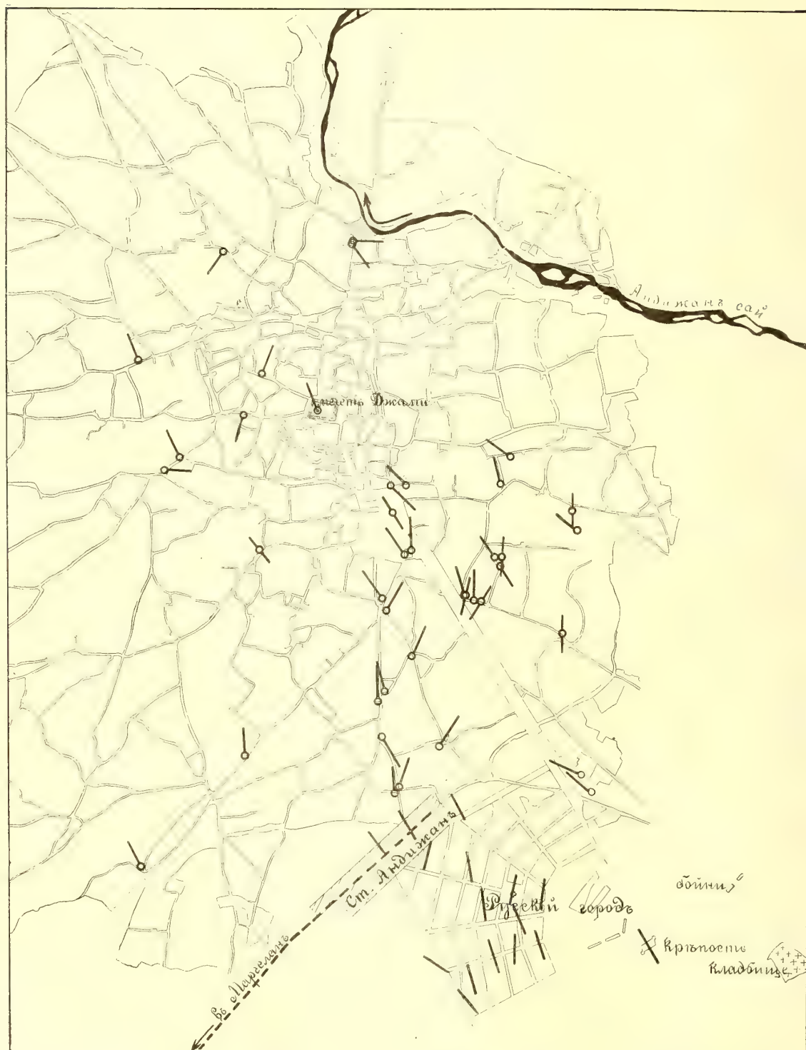
Фиг. 6. Направленія сотрясеній въ туземномъ городѣ, опредѣленныя по типичнымъ разрушеніямъ.
