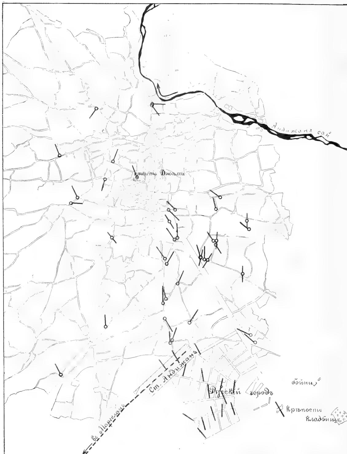
Фиг. 6. Направленія сотрясеній въ туземномъ городѣ, опредѣленные по типичнымъ разрушеніямъ.
