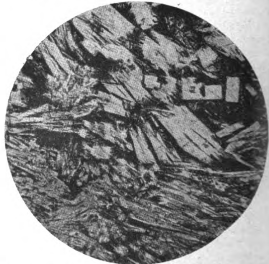
Abb. 3. Künstliche Sillimanit-Schmelze mit ausgeschiedenen Kristallen von Aluminiumsilikat, \text{Al}_2\text{SiO}_5 (Sillimanit). Vergr. 330fach.
