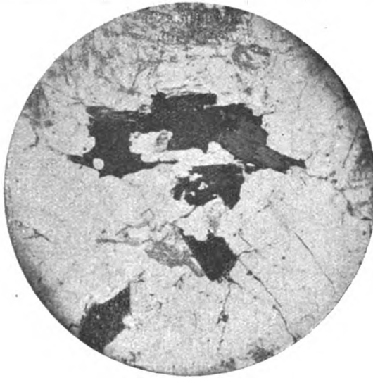
Abb. 4. Granit von Ramberg im Harz. Körnige Struktur; Magnetit (Biotit) in der Mitte, das übrige ist ein Gemenge von Quarz- und Feldspatörnern. Berg. 15fach.
