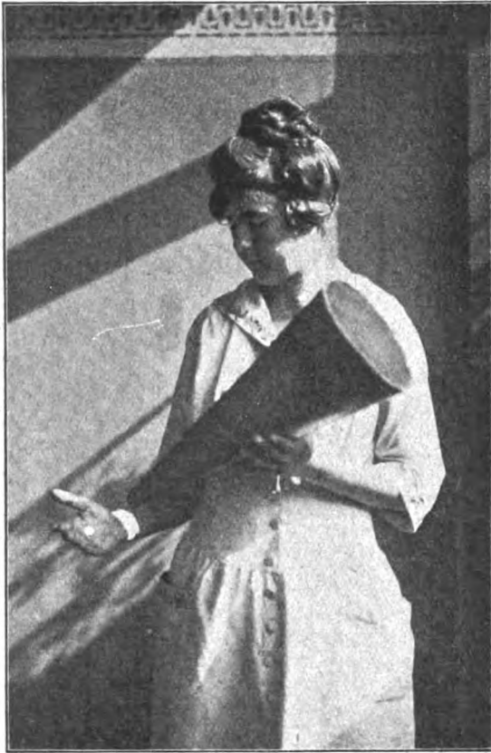
Abb. 41. Sammlung der Sonnenstrahlen durch einen blanken Metallkegel.
