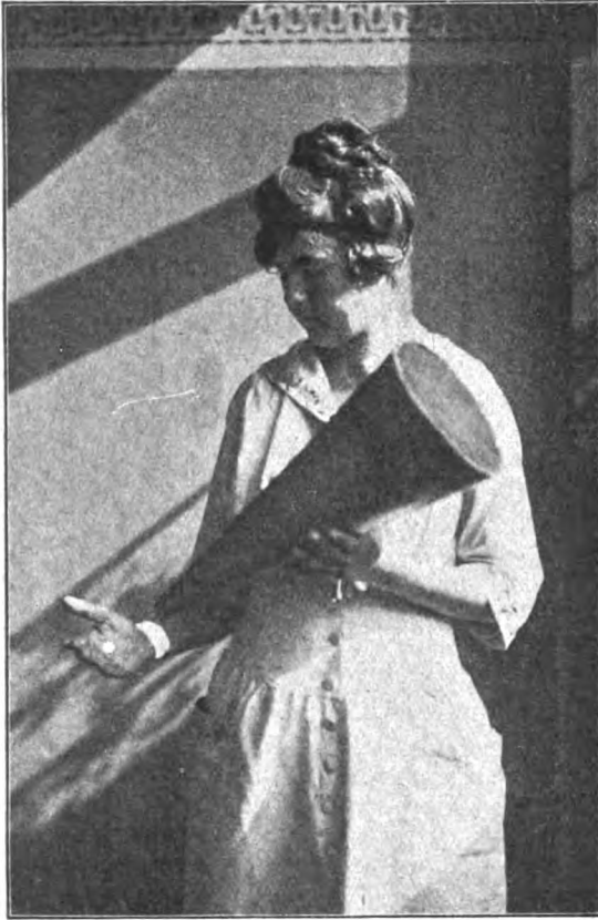
Abb. 41. Sammlung der Sonnenstrahlen durch einen blanken Metallblech.
