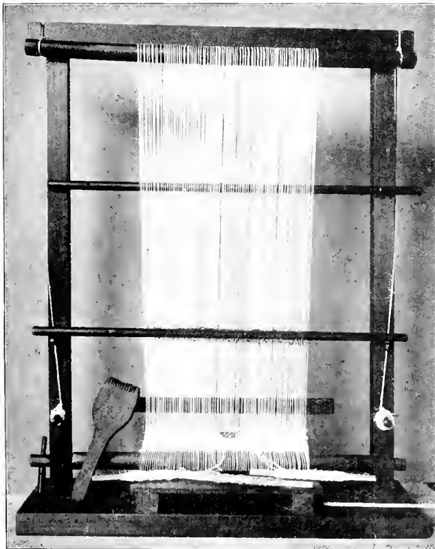
Abb. 53. Rekonstruktion des ägyptischen Gobelinwebstuhls. Modell im Berliner Museum.
