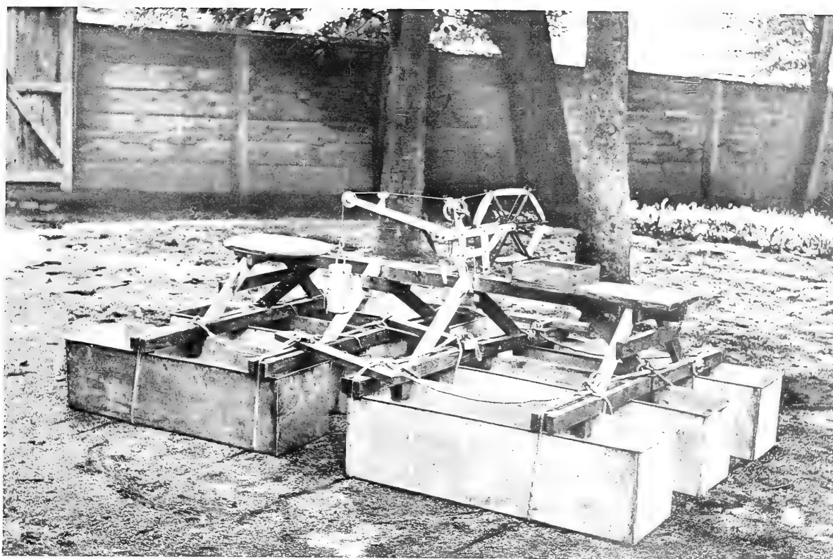
Nr. 1. Zusammenlegbarer Kahn mit aufgeschraubtem Lotapparat.
