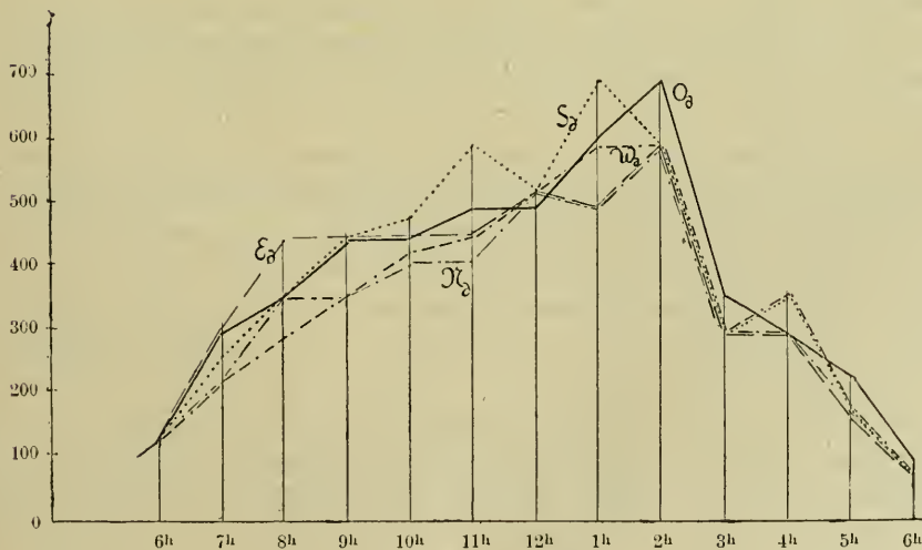
Fig. 11. Tageskurven des gesamten und des diffusen Lichtes vom Oberlicht O und dem Vorderlicht der vier Himmelsrichtungen N, E, S, W eines Tages von hohem Sonnenstand.
