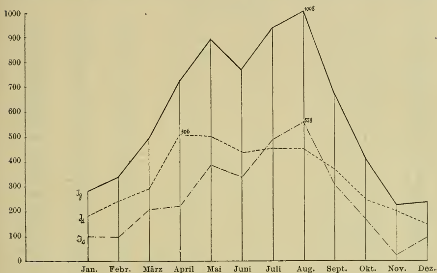
Fig. 6. Monatsmittel der Mittagsintensitäten des gesamten, direkten und diffusen Lichtes aus allen Tagen.
