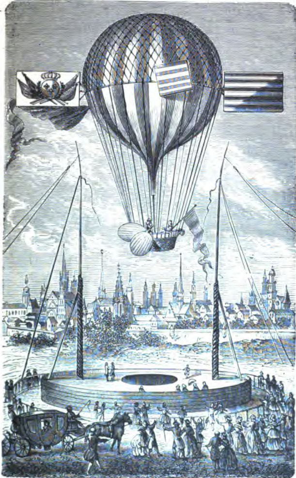
Fig. 10. — Le ballon à rames, de Guyton de Morveau; aérostat l'Académie de Dijon, expérimenté le 12 juin 1784. (D'après une gravure du temps.)
