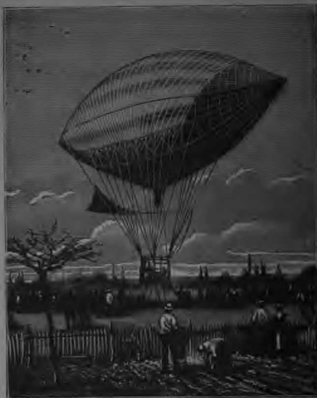
Fig. 31. — L'aérostat électrique à hélice de MM. Tissandier frères, au 1000 e quartier (D'après une photographie de l'aérostat arrimé à terre.)
