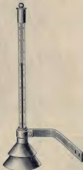
Abb. 44. Fensterthermometer mit Hellmann'schem Strahlungsschutz. Von R. Sueß in Steglitz-Berlin.
