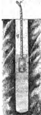
aa. Bohrloch. bb. Niveau des Sprengöls. cc. Holzzündern. d. Korf des Zünders. e. Pulverkammer des Zünders. f. Zündschnur. g. Besatz aus losem Sand.
