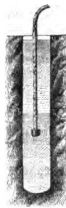
aa. Bohrloch. bb. Niveau des Sprengöls. cc. Niveau des Wasser. dd. Zündhütchen. e. Patent-Zündhütchen.
